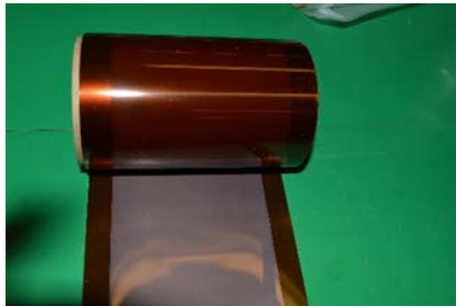
Foil 1 micron on Kapton
